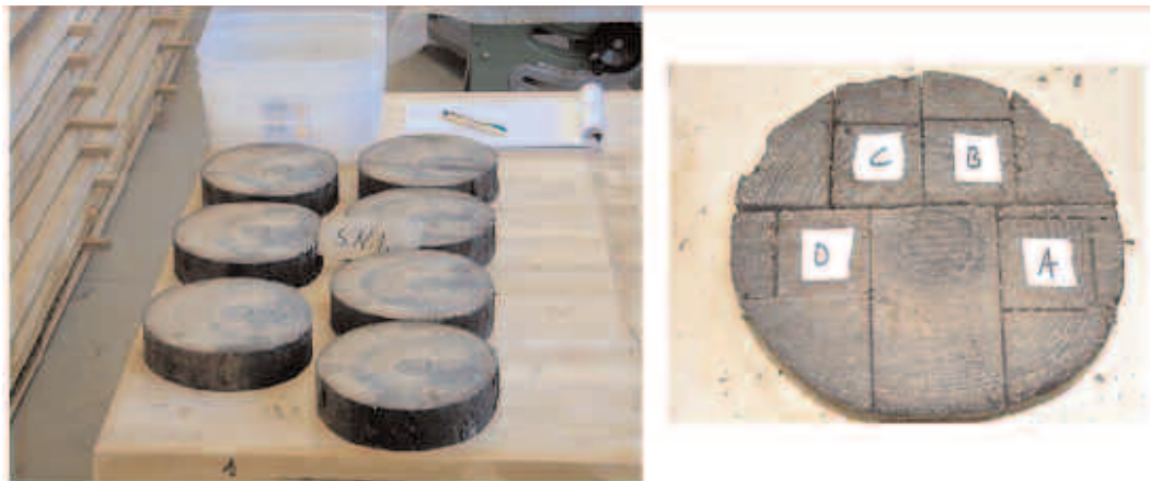
Figura 1. Preparazione di cuboidi per la sperimentazione, legno di pino marittimo
